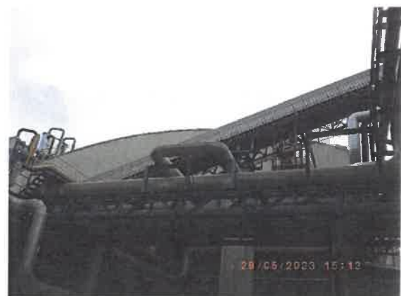
ภาพที่ 2.3-12 ระบบสายพานลำเลียงกากอ้อยระบบปิด
