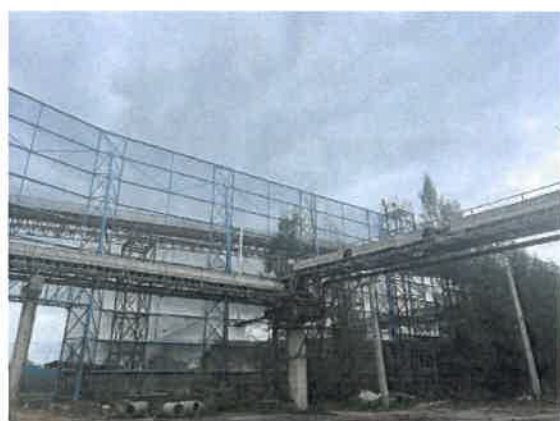
ภาพที่ 2.3-65 ระบบสายพานลำเลียงกากตะกอนหม้อกรองระบบ ปิด
